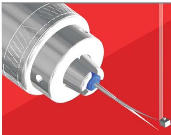
**Figura 1** - Dispositivo usado no ensaio mecânico de flexão em cantilever.
