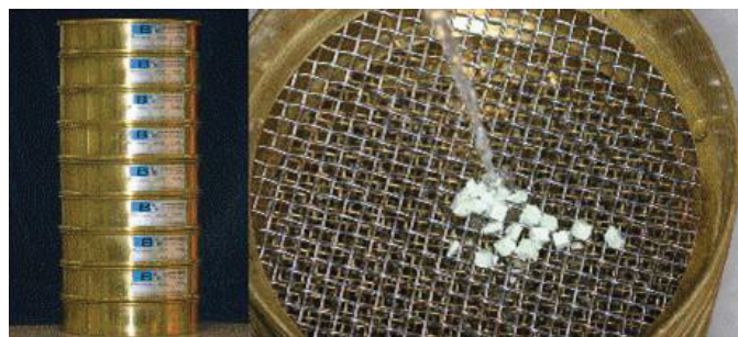
Figura 1. Conjunto de peneiras granulométricas (Tamises), agrupadas em relação por diâmetro da peneira, a direita fragmentos de "Optocal" capturado.
