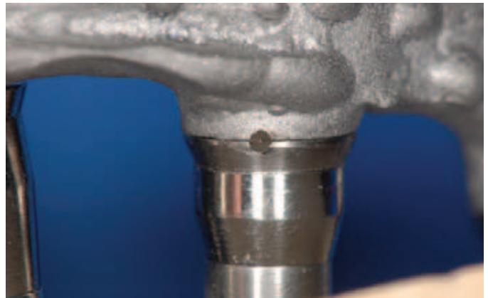
Figura 6. Etapa inicial de soldagem com único disparo para união das bordas da infraestrutura e cilindros clínicos.
