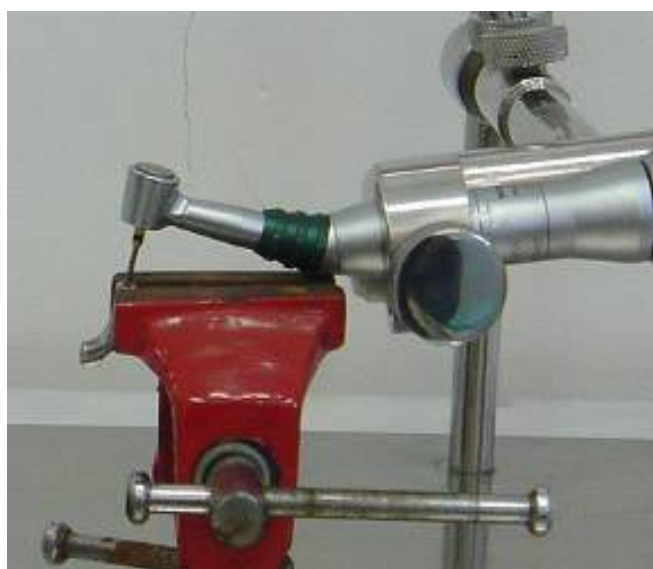
Figura 4: Dispositivo mecânico empregado no ensaio de flexão rotativa.
