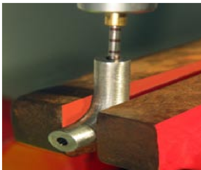
Figura 5: Detalhe do instrumento endodôntico posicionado no interior do canal artificial.
