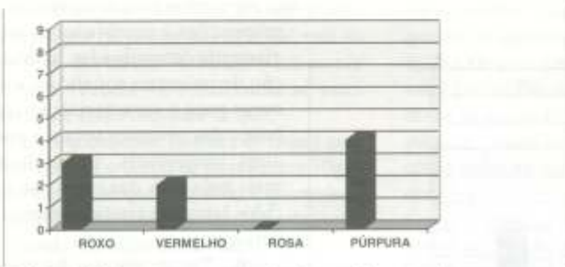
Gráfico 5 - Número e cores encontradas em 64 corpos de prova, mantendo-se a quantidade fixa de 10g de resina rosa, excluindo-se a resina amarela nº 66 e variando a resina vermelha em 5,3 e 1g e o grafite em 10,5 e 2,5mg
