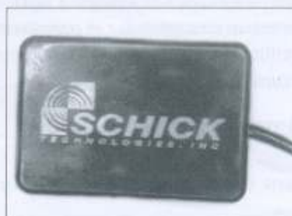
FIGURA 1 - Receptor utilizado por sistemas diretos do tipo CCD.
