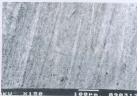
Figura 5 - Fotomicrografia eletrônica de varredura do grupo instrumentado com lima periodontal nº 9, com aumento de 150 vezes.
