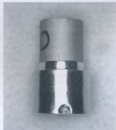
Figura 2 - Corpo-de-prova fundido e adaptado ao troquel
