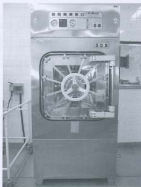
Figura 7 - Autoclave de barreira, pré-vácuo e automatizada
