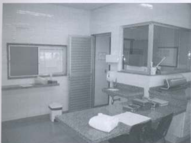
Figura 5 - Central de Material e Esterilização (CME) – barreira física, parede, que separa a área de preparo da área de armazenagem/estocagem
