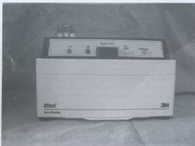
Figura 9 - Monitoramento do processo de esterilização: incubadora para teste biológico com leitura de 3 horas
